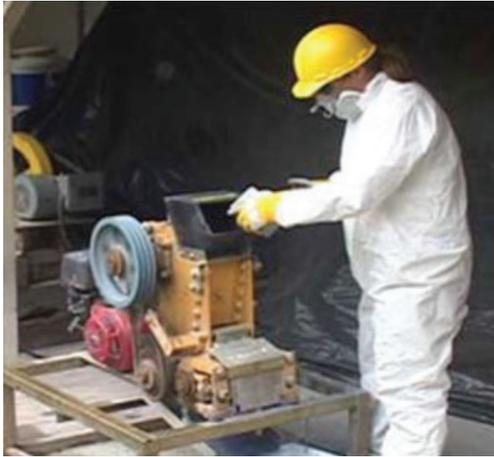
**D**imensions : dans ce broyeur le minerai y entre de la taille d'une balle de golf et en sort de la taille d'un haricot de Lima.
